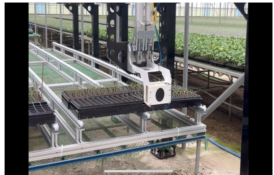
그림 11. 이동하며 촬영하는 Loading Robot Fig. 11. Loading Robot to shoot while on the move
